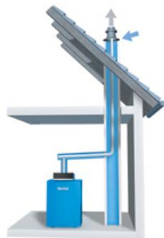
Raumluftunabhängig mit konzentrischem Luft-Abgas-System aus Kunststoff im Schornstein oder Schacht
