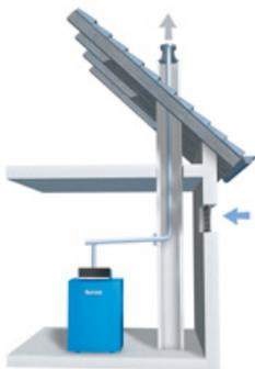
Raumluftabhängig mit eingezogenem Abgasrohr im Schornstein (Zuluft über Belüftungsöffnung)
