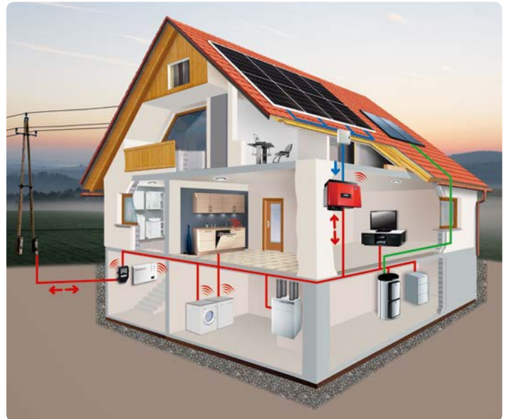
Vaillant Systemhaus mit Solarthermie und Photovoltaik
