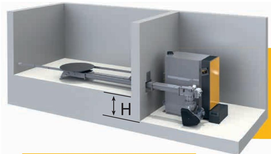
**ETA-Tipp:** Für eine waagrechte Austragung ist folgender Höhenunterschied zwischen Lagerraum und Heizraum nötig:
