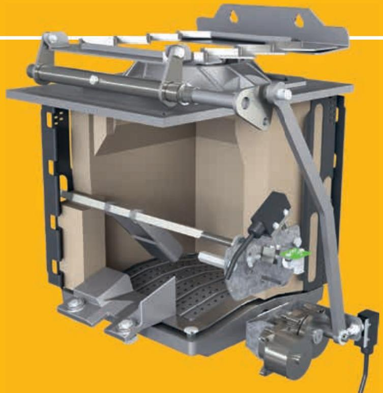
**Optimierte Zündung spart Energie.** Bei kurzen Feuerpausen bleibt die Schamottbrennkammer heiß genug, damit sich frisch eingeschobenes Brennmaterial einfach an der Restglut entzündet. Nur nach längerem Kesselstillstand kommt die geräuschlose Zündung zum Einsatz. Sobald Lambdasonde und Abgastemperaturfühler signalisieren, dass der Zündvorgang erfolgreich war, schaltet sich die Zündung sofort ab. Das spart Energie!
